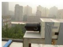
La Universidad Tecnológica de Chalmers empleará un par de sistemas DOAS (por sus siglas en inglés, espectrómetro diferencial de absorción óptica) móviles para medir emisiones de SO2 del área industrial de Tula y las emisiones de NO2 y SO2 de la parte sur de la Ciudad de México.
